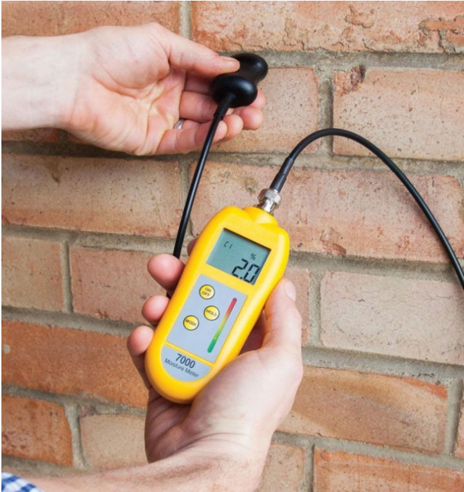
Misura con sonda a contatto/puntali su muratura
