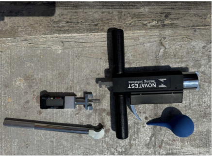
Penetrometro NOVATEST con dispositivo di battuta, puntale di penetrazione e comparatore digitale per la misura degli avanzamenti.
