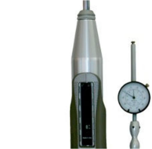
Woodtester e comparatore - strumentazione utilizzata
