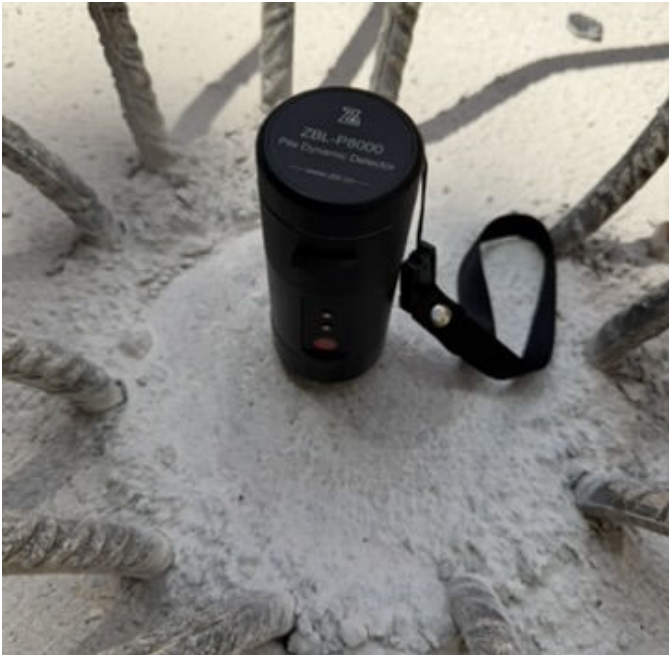
Posizionamento del sensore sulla testa del palo
